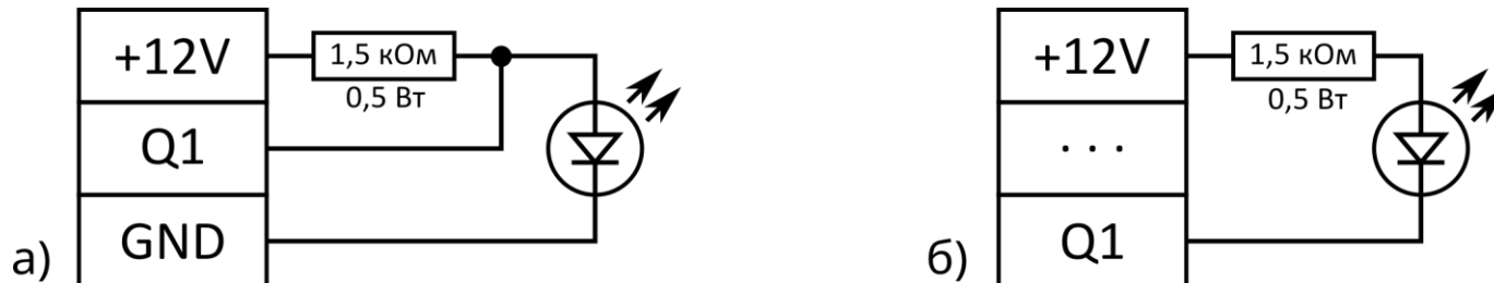
Рисунок 2.2 - Схемы подключения индикаторов «Подтверждение» к выходу клавиатур:
